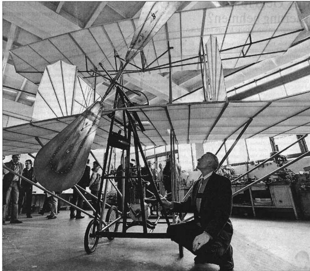
Harald Lohmann baute den Flieger von Karl Jatho aus dem Jahr 1903 originalgetreu nach – mitsamt allen Fehlern. Herausgekommen ist eine Mischung aus Drachen, Doppeldecker und Gokart mit Treckersitz und Fahrradlenker, 360 Kilogramm schwer und acht Meter breit.
